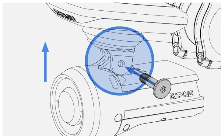
**2.** Als nächstes die mitgelieferte Schraube in die Bohrung der Halterung stecken und festziehen. Hier ist unbedingt darauf zu achten die Schraube so zu fixieren, dass sich die Lampe nicht von selbst bewegen kann – auch nicht im Gelände.
